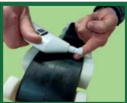
**Achtung! Nur bei KTW/W270:** Mit dem mitgelieferten **4 pipes Gleitmittel** werden die einzelnen **Gelenke jeweils auf der inneren und äußeren Seite** eingestrichen. Auch die Gelenke an den **beiden Enden** werden mit Gleitmittel eingestrichen.
