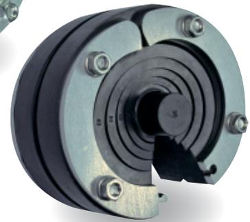
Die **Pressio® Universal Ringraumdichtung** ist als **Einzel-durchführung** oder als Blindverschluss einsetzbar. Aufgrund ihres weichen Gummis sind die Pressio® Universal Ringraumdichtungen besonders für Kunststoffrohre geeignet. Der Dichtbereich für die Durchführung eines Rohres/ Kabels ist mit Gummilamellen abgestuft und somit für verschiedene Außendurchmesser einsetzbar.
