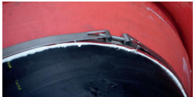
4 pipes Gelenkbolzenband ab **DA 315 mm**
