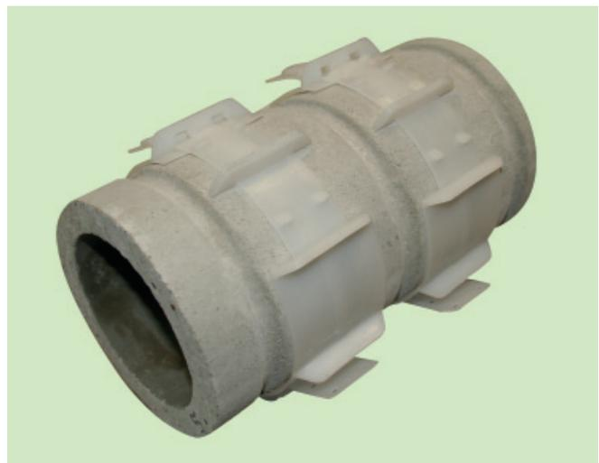
Mauerhülse mit Abstandhaltern ICD Höhe 15 mm zur Zentrierung in der Kernbohrung bei Nasseinbau.
