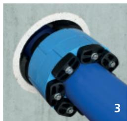
3. Es kann sein, dass die Kette leicht durchhängt. **Es dürfen keine Elemente aus der Kette genommen werden.** Es kann erforderlich sein, dass die Kette bei kleineren Rohrdurchmessern leicht gedehnt werden muss.
