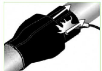
Bei Konturen wie z.B. Muffenverbindungen wird **zuerst auf die Muffe und dann auf das Spitzende** geschrumpft.
