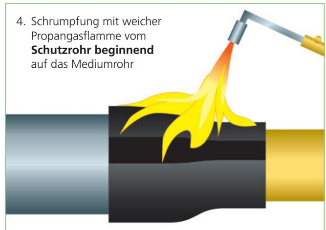
4. Schrumpfung mit weicher Propangasflamme vom **Schutzrohr beginnend** auf das Mediumrohr
