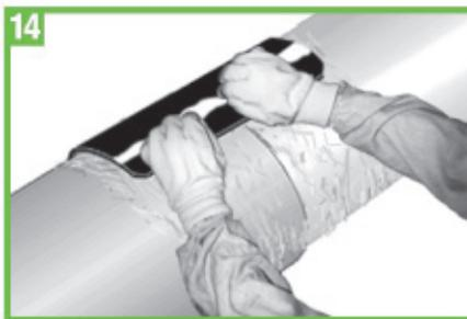
Das Ende des Superseal Produktes mittig über den Übergangsbereich Muffenrohr/Mantelrohr und senkrecht zur Rohrachse etwa auf dem Rohrscheitel plazieren, den erwärmten Bereich mit dem Handballen fest andrücken.
