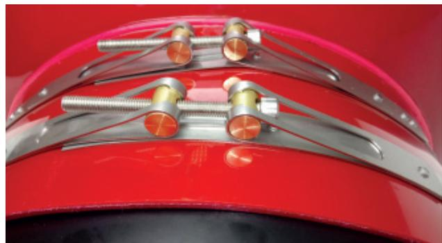
**Angezogene Gelenkbolzenspannbänder mit schweißpunktfreier TOX-Verbindungstechnik. (Bei 4 pipes gefertigt; für Rohrdimensionen  $\geq$  DN 300)**
