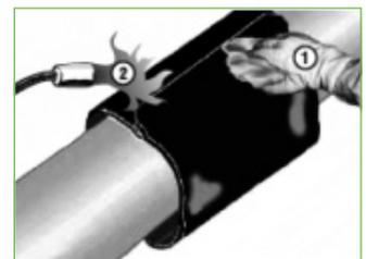
Die Überlappung wird mit einem **Verschlussstreifen verklebt**. Hierzu wird dieser auf der Kleberseite leicht erwärmt, auf die Überlappung geklebt und dann von oben durch andrücken und erwärmen vollständig verklebt. **Erst bei guter Haftung des Verschlusses kann die Schrumpfung beginnen**.
