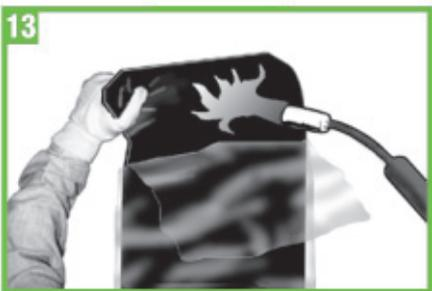
Ecken der Manschette einseitig ca. 20 x 50 mm abschneiden für spätere Unterlappung. Trennfolie ca. 15 cm vom Ende der Schrumpfmanschette (Unterlappung) abziehen und den Schmelzkleber mit der Propanflamme kurz anwärmen.
