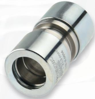
Das HAELOK® THERMO-Fitting «SR» (Straight Repair Fitting) wird für eine gerade Verbindung von zwei Fernwärmehohrleitungen benutzt. Das Fitting kann über das ganze Rohr verschoben werden um Reparaturen auszuführen. Es ist speziell optimiert auf hohe Auszugskräfte, Temperaturlastwechsel und für den Einsatz nach den aktuellen Vorgaben der AGFW FW 449. Das Fitting besteht aus insgesamt drei fix montierten Bauteilen; einem Grundkörper und zwei Pressringen.
