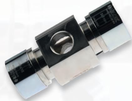
Das HAELOK®- Fitting, Typ «D2» (Distributor 2 Outlets), besitzt zwei seitliche Abgänge mit G ½" Gewinde und kann als Messstelle oder zum einschrauben von Löschdüsen verwendet werden. In Verbindung mit Gewindeteilen TE-\_\_-G12\_ kann leicht ein Abgang oder Kreuzstück realisiert werden. Das Fitting besteht aus insgesamt drei fix montierten Bauteilen; einem Grundkörper und zwei Pressringen.
