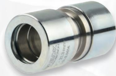
Das HAELOK®- Fitting, Typ «SR» (Straight Repair) wird für eine gerade Verbindung von zwei Rohren benutzt. Durch den fehlenden Anschlagsteg kann das Fitting über das ganze Rohr verschoben werden um Reparaturen auszuführen. Das Fitting besteht aus insgesamt drei fix montierten Bauteilen; einem Grundkörper und zwei Pressringen.
