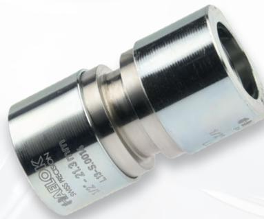
Das HAELOK®- Fitting, Typ «SF» (Straight Fitting), wird für eine gerade Verbindung von zwei Röhren benutzt. Das Fitting besteht aus insgesamt drei fix montierten Bauteilen; einem Grundkörper und zwei Pressringen.
