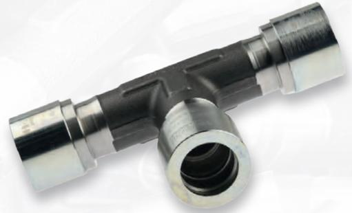
Das HAELOK®- Fitting, Typ «T3» (Equal-T), wird als Verbindung zwischen drei Rohren benutzt. Das Fitting besteht aus insgesamt vier fertig montierten Bauteilen; einem Grundkörper und drei Pressringen. Sonderanfertigungen mit ungleichen Abgängen (TR/T-reduziert) sind möglich.
