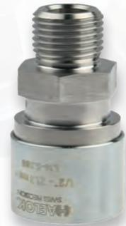
Das HAELOK®-Fitting, Typ «TE» (Thread External), wird zum Anschliessen von Armaturen wie Pumpen oder Ventilen benutzt. Generell wird das Gewinde nach Typ «B» mit Dichtkante gefertigt. Das Fitting besteht aus insgesamt zwei fix montierten Bauteilen; einem Grundkörper und einem Pressring. Sonderanfertigungen mit Spezialgewinde z.B. NPT sind möglich.
