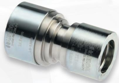
Das HAELOK®- Fitting, Typ «RE» (Reducer), wird für eine gerade Verbindung von zwei Rohren mit unterschiedlichen Durchmessern benutzt. Das Fitting besteht aus insgesamt drei fix montierten Bauteilen; einem Grundkörper und zwei Pressringen verschiedener Grössen.
